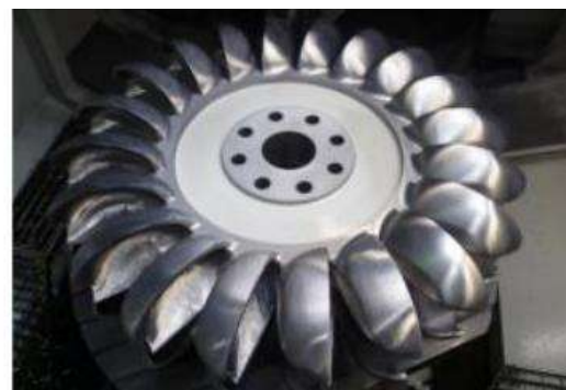
Turbine Pelton (similaire à celle utilisée pour le projet)
