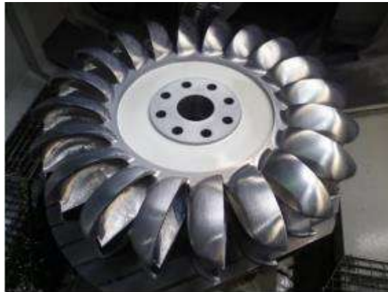
Chap. II - Figure 20 : Exemple de turbine Pelton
